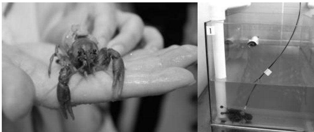
Рис. 1. Рак Cambaroides schrenckii : с приклеенным для датчика «седлом» (слева); с прикрепленным датчиком, в рабочем аквариуме (справа).
